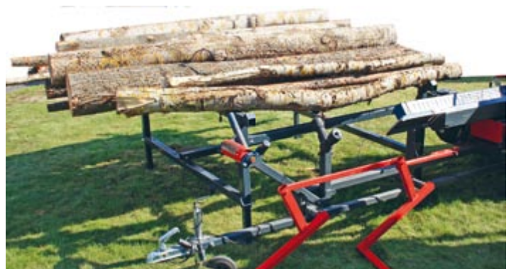
Stockbordet underlättar och påskyndar inmatningen av stockar i maskinen.
